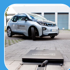
Figuur 2: Draadloos laden via inductieplaat
